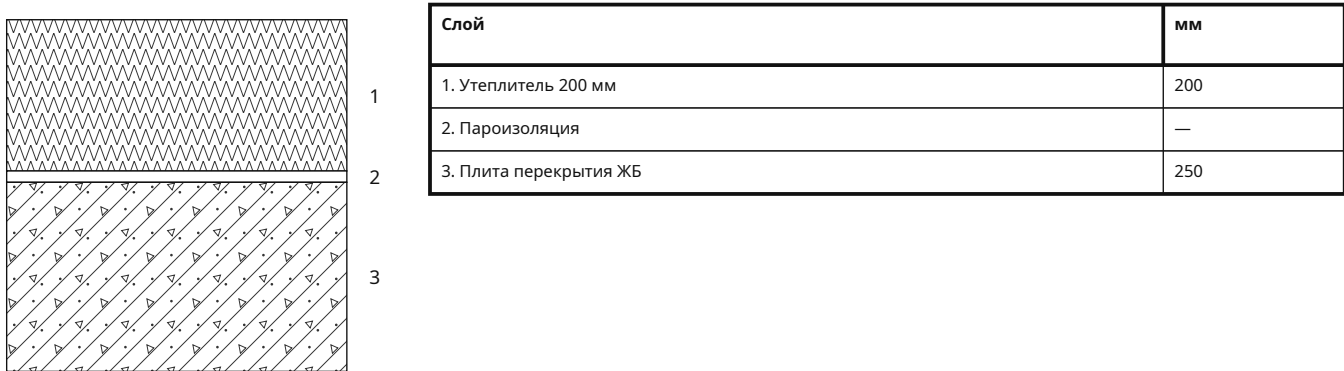
ПК-1 · Чердачное перекрытие холодного чердака, сверху вниз
