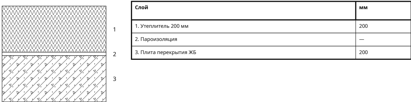
ПК-1 · Чердачное перекрытие холодного чердака, сверху вниз
