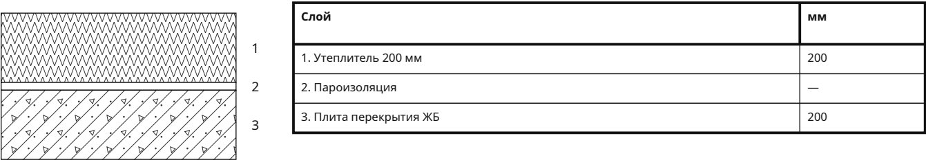
ПК-1 · Чердачное перекрытие холодного чердака, сверху вниз
