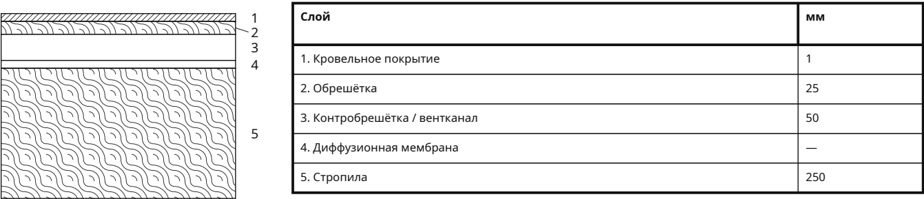
КРВ-1 · Скатная кровля, снаружи внутрь
