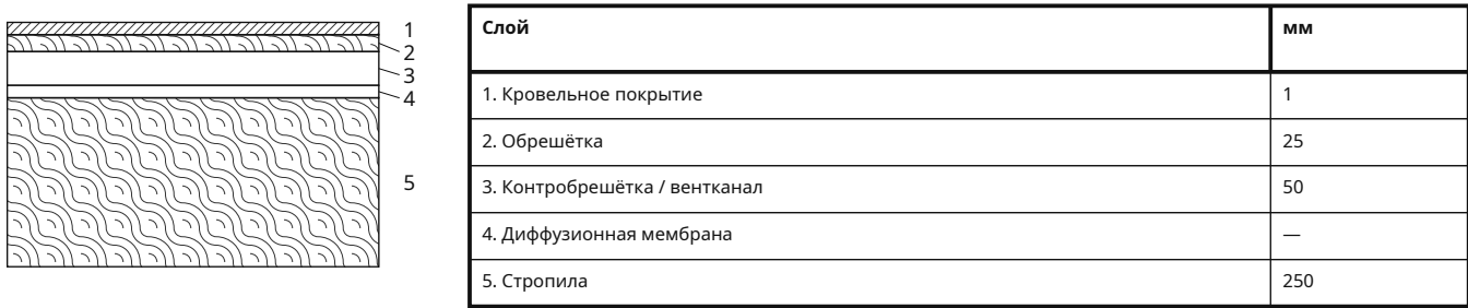
КРВ-1 · Скатная кровля, снаружи внутрь
