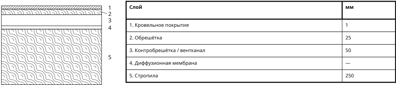
КРВ-1 · Скатная кровля, снаружи внутрь
